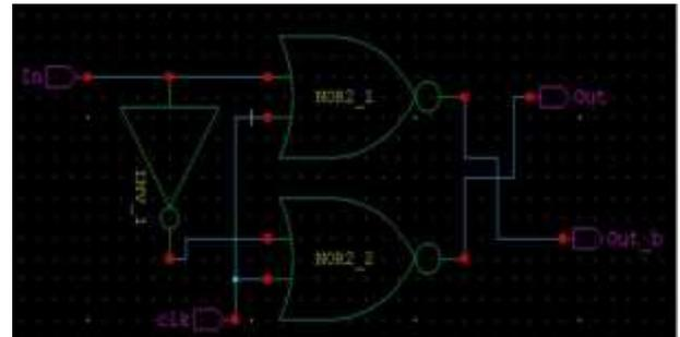
Fig. 1 WDDL INVERTER
